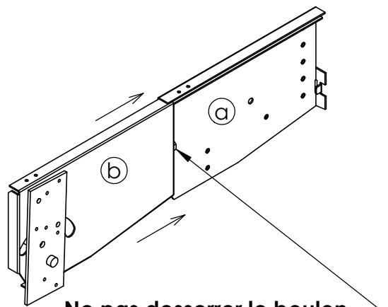
**Ne pas desserrer le boulon à l'arrière du mécanisme.
