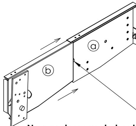
**Ne pas desserrer le boulon à l'arrière du mécanisme.**
